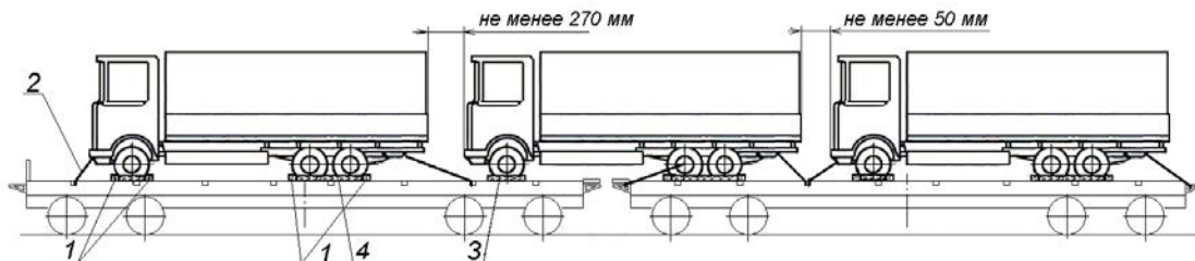
Рисунок 13 – Размещение и крепление техники на колесах с пневматическими шинами на сцепе платформ
